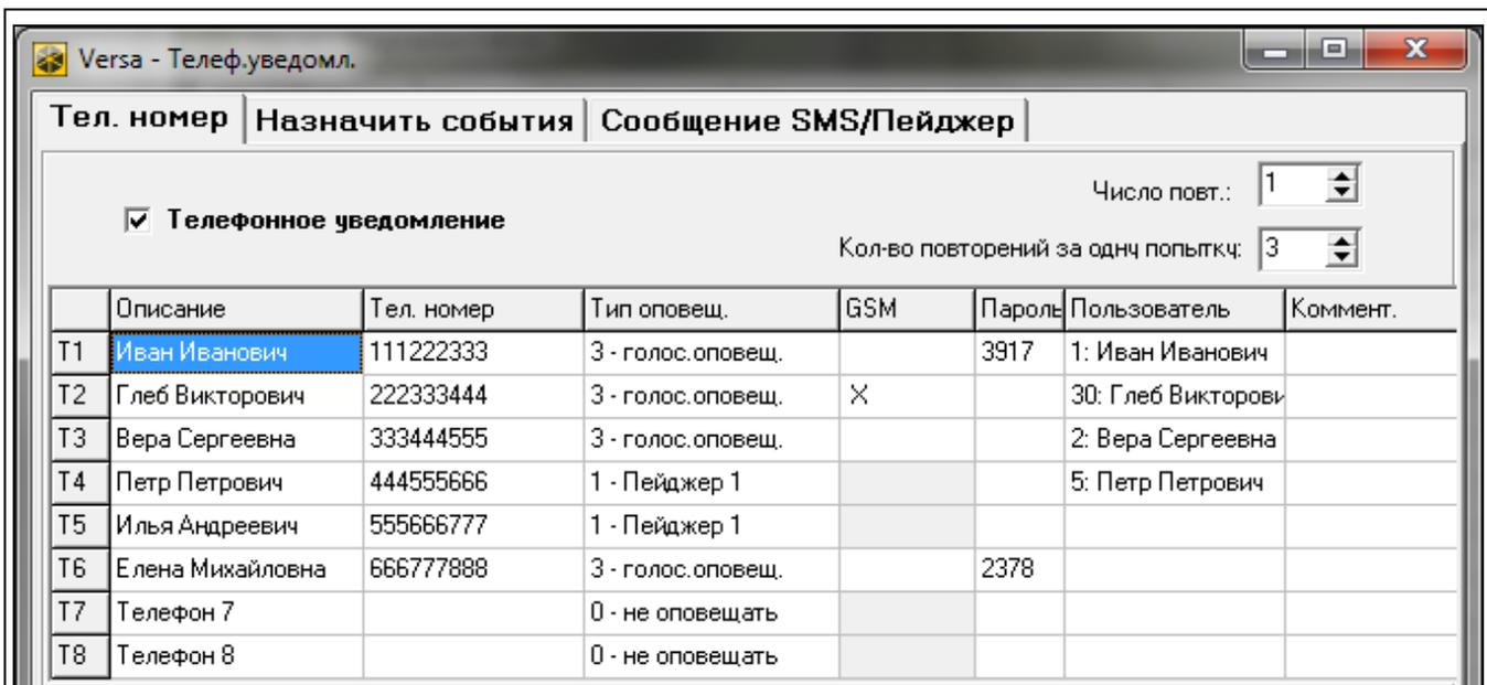
Рис. 24. Программа DLOADX: настройка параметров телефонного уведомления.
