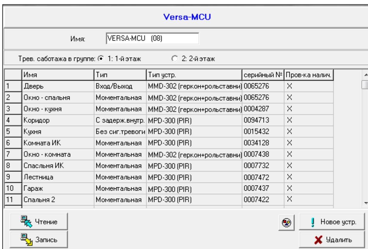
Рис. 18. Программа DLOADX: настройка контроллера и извещателей беспроводной системы 433 МГц.
