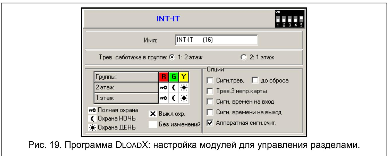
Рис. 19. Программа DLOADX: настройка модулей для управления разделами.
