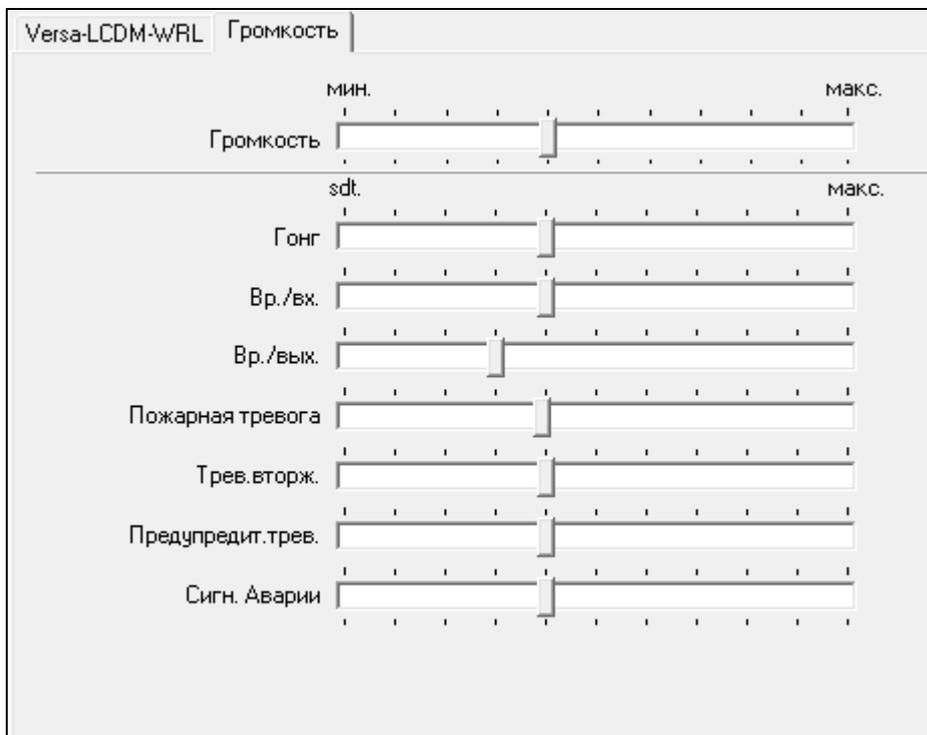
Рис. 16. Программа DLOADX: настройка громкости клавиатуры.
