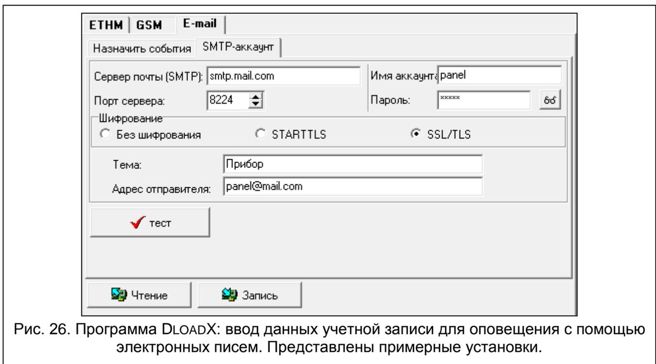
Рис. 26. Программа DLOADX: ввод данных учетной записи для оповещения с помощью электронных писем. Представлены примерные установки.
