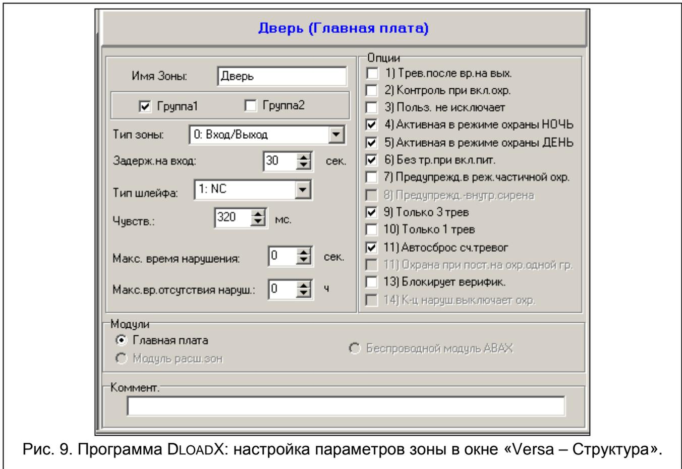
Рис. 9. Программа DLOADX: настройка параметров зоны в окне «Versa – Структура».
