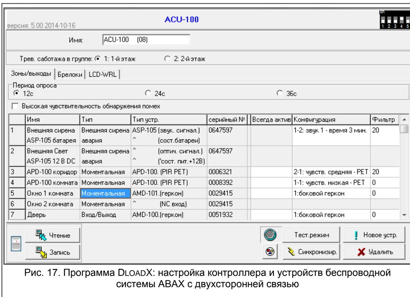
**Синхронизация** – функция включает процедуру синхронизации, то есть проверяет, работают ли другие беспроводные системы в пределах дальности действия контроллера беспроводной системы AVAX, и если так, то подстраивает под них период опроса, так чтобы исключить взаимные помехи. Синхронизация осуществляется автоматически при запуске контроллера, а также после каждой операции добавления/удаления беспроводных устройств.
