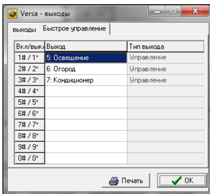
Рис. 11. Программа DLOADX: назначение выходов клавишам клавиатуры.
