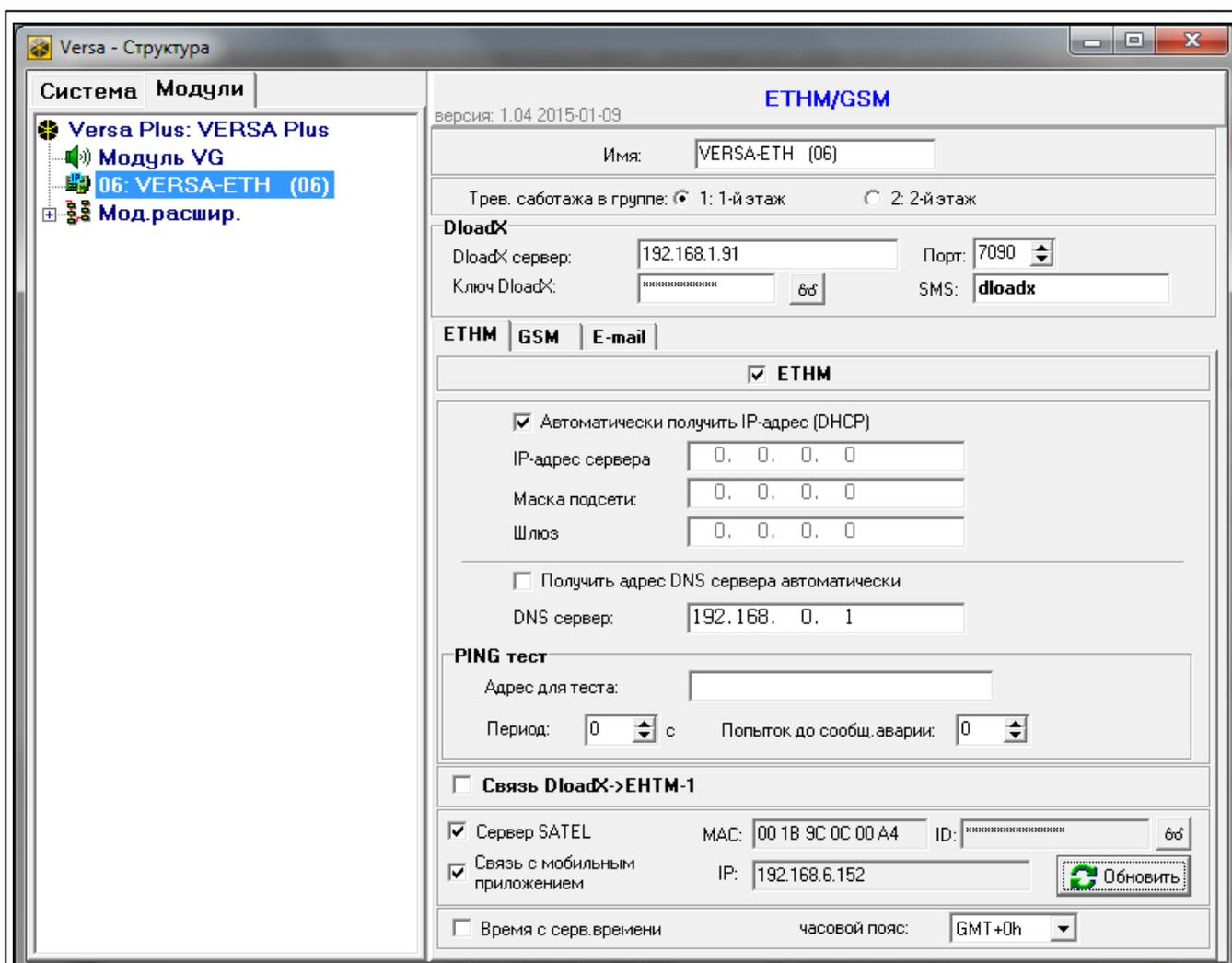
Рис. 13. Программа DLOADX: настройка встроенных интерфейсных модулей связи.
